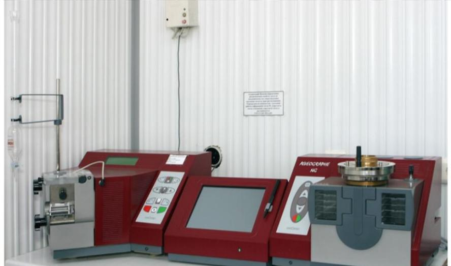
Альвеограф Chopin – прибор используется для определения реологических свойств теста по оказываемому сопротивлению давлению воздуха (при растягивании).
